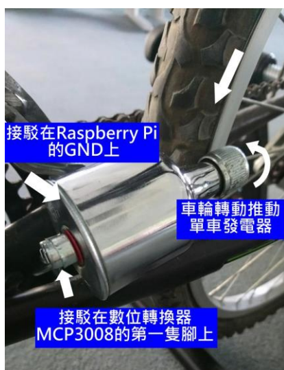
圖九 單車後輪的生電裝置
