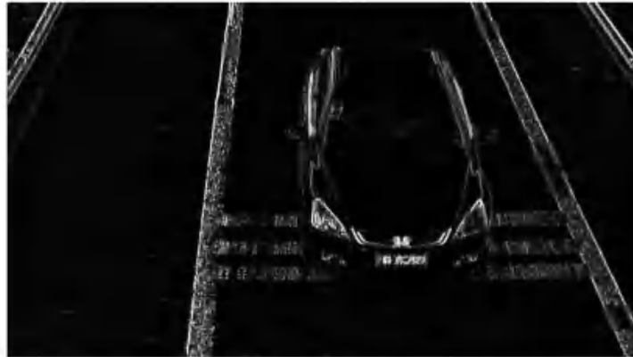
图 3-12 Sobel 算子检测边缘后的效果图
