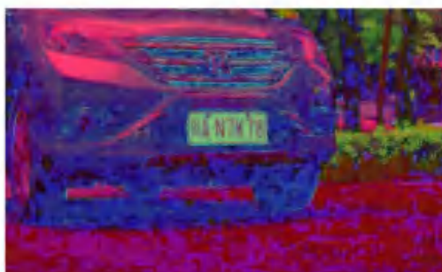
图 3-5 HSV 颜色空间转换对比图
