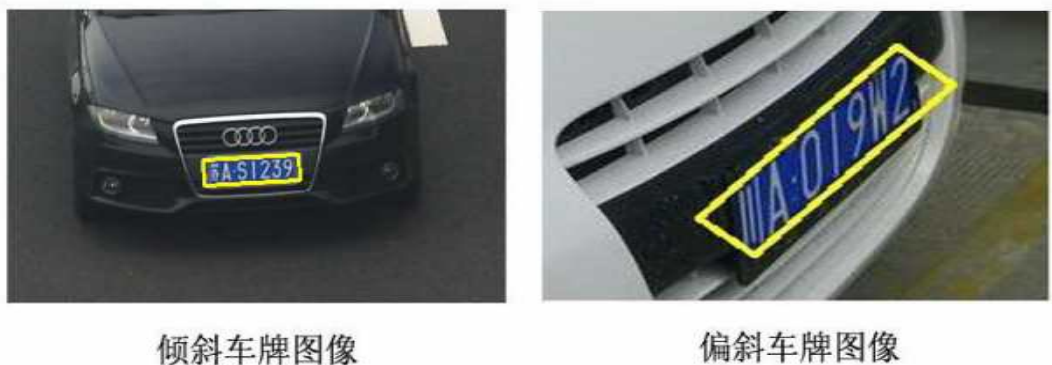
图 3-24 倾斜和偏斜车牌图像的对比图
