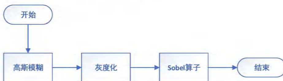
图 3-8 基于 Sobel 的边缘检测的车牌定位方法流程图
