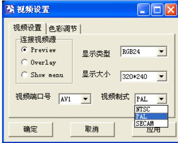
可以设定图像制式以和从摄像头传输过来的视频信号对应，目前国内的模拟摄像头基本是 PAL 制式的。
