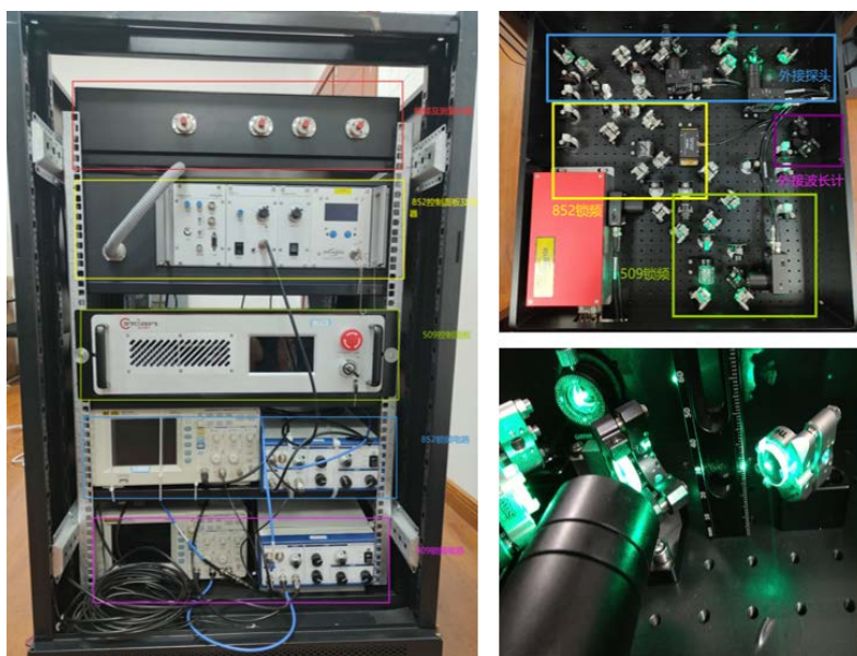
图1 里德堡超外差接收机图示
