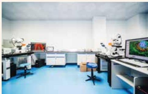
先进的仪器设备——激光共聚焦扫描显微镜
